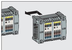
Das verkabelte Modul wird rechts an die bereits vorhandene Basis aufgesteckt. Die Verkabelung wurde zum besseren Verständnis in den Montagebildern weggelassen.
