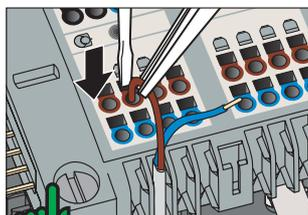
**TIP!** Bei flexiblen Adern die Klemme mittels Schraubendreher öffnen und einstecken.
