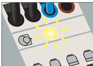
Funktionsanzeige leuchtet, wenn der Regler Spannung auf den Antrieb schaltet.
