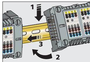
Unterteil auf die Tragschiene aufclippen und die Verkabelung durchführen. Danach das Modul mit der Basis (oder vorhandenen Modulen) verbinden.
