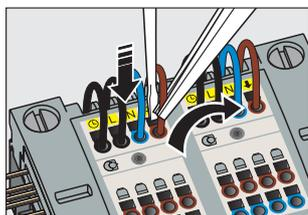
Mittels Schraubendreher Klemme öffnen und Leitung herausziehen
